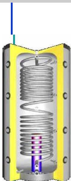
Ballon tampon à stratification, avec isolation, production d'eau chaude sanitaire instantanée par tube inox flexible, 4 départs et retours, manchon pour résistance électrique, isolation épaisseur 100 mm
