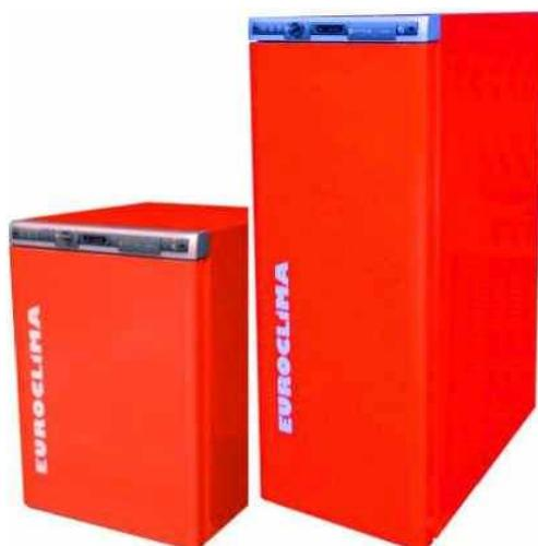
Chaudière fioul condensation, puissance de 24 et 32 kW, Chauffage seul ou Chauffage et production eau chaude sanitaire, Corps de chauffe deux départs pour couplage aisé avec chaudière bois, Pac, solaire.
