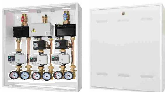
Coffret de distribution équipé d'un séparateur hydraulique, raccordement jusqu'à trois modules de départs, vanne de départ et retour, purgeur automatique
