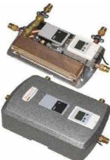
Module hydraulique pour la production d'eau chaude instantanée, avec réglage de la température sanitaire par vanne de mélange thermostatique de 35 à 65°C, équipé d'un échangeur à plaque, circulateur et régulation ECS, livré monté et câblé, fixation murale
