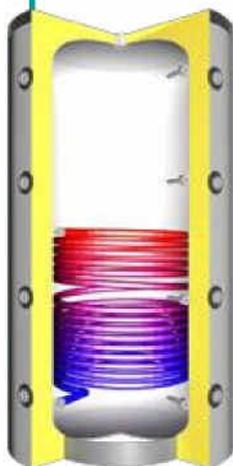
Ballon tampon acier avec isolation, 4 départs et retours, manchon pour résistance électrique, isolation épaisseur 100 mm, échangeur solaire
