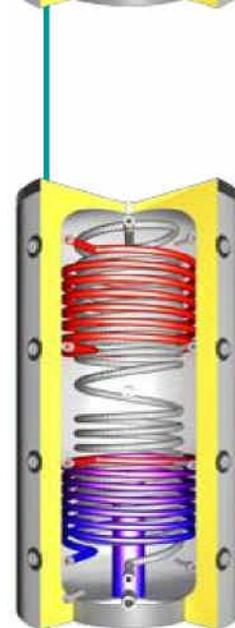
Ballon tampon à stratification, avec isolation, production d'eau chaude sanitaire instantanée par tube inox flexible, 4 départs et retours, manchon pour résistance électrique, isolation épaisseur 100 mm, deux échangeur solaire .
