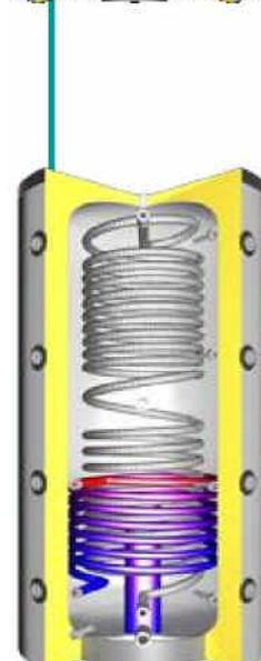
Ballon tampon à stratification, avec isolation, production d'eau chaude sanitaire instantanée par tube inox flexible, 4 départs et retours, manchon pour résistance électrique, isolation épaisseur 100 mm, échangeur solaire
