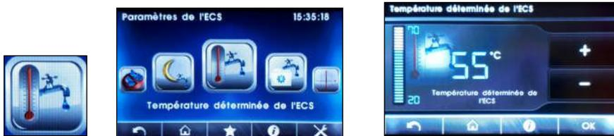
Réglage du mode de fonctionnement de la production d'eau chaude sanitaire
