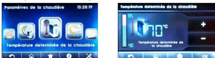
Réglage de la température de consigne de la chaudière en mode automatique
