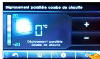
**PARAMETRAGE DE LA COURBE DE CHAUFFE CIRCUIT 1**
