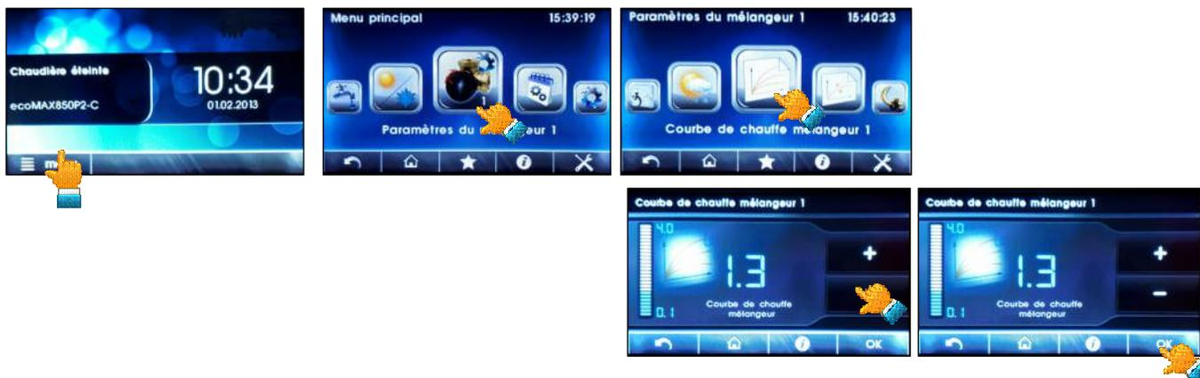
Dans le cas d'un plancher chauffant, il est nécessaire de paramétrer la température de départ maxi:
