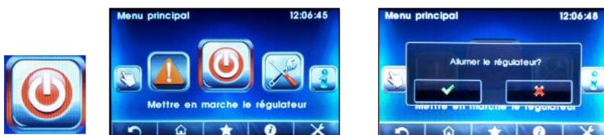
Permet d'allumer au d'éteindre la chaudière.
