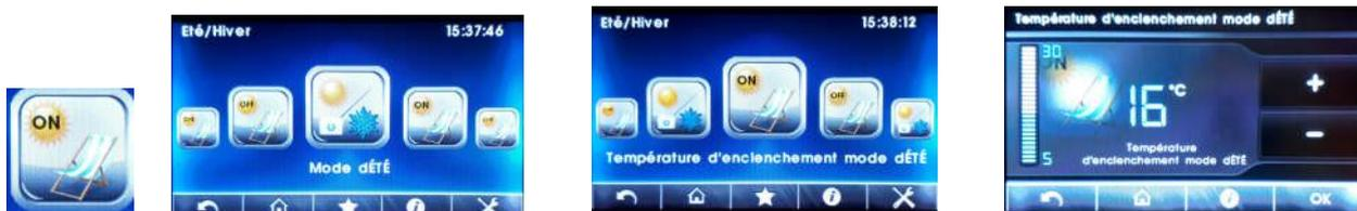
Si la température extérieure dépasse la température réglée, le chauffage s'arrête
