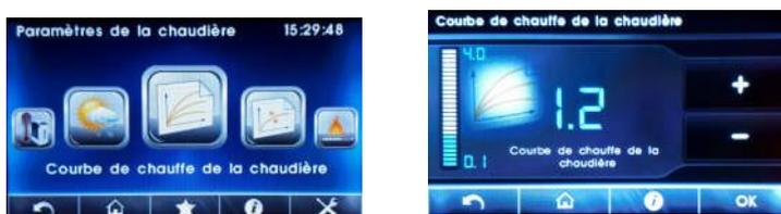
Uniquement possible si raccordement de la sonde extérieure.
