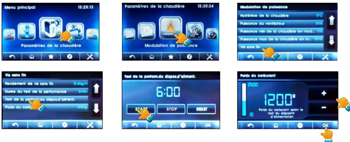
Cette mesure est à effectuer à la livraison des granulés, ou si un défaut de combustion est constaté (dégagement de fumées dans le conduit de fumées, manque de puissance de chauffe, problème d'allumage...)
