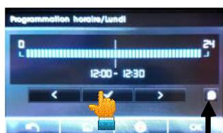
Déplacer le curseur sur l'heure souhaitée, valider, les barres réduites correspondent à un chauffage réduit, les barres normales au chauffage
