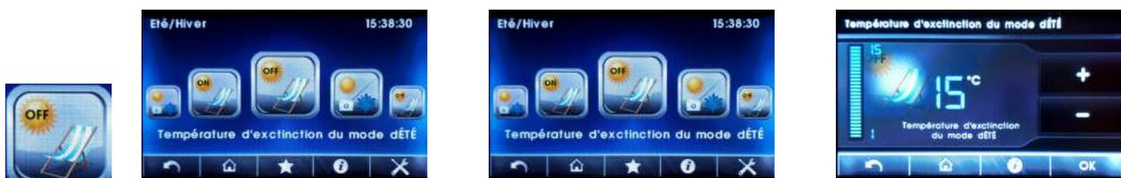
Si la température extérieure redescend sous la température réglée, le chauffage redémarre
