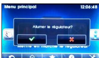
Permet d'allumer ou d'éteindre la chaudière. En cas d'arrêt, certains composants de la chaudière peuvent encore fonctionner un certains temps (ventilateur, vis de sécurité, moteur de nettoyage) avant l'arrêt complet de la chaudière.
