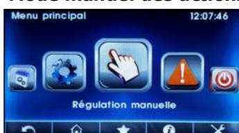
Permet de tester manuellement tous les actionneurs de la chaudière
