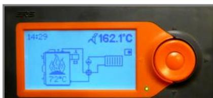
La chaudière est en fonctionnement normale lorsque la température de fumées dépasse 110° (température de fin de combustion (  $\curvearrowright$  end) + 20°). Le servo moteur et le ventilateur modulent. Le clignotement du symbole de la pompe de charge indique qu'elle est en fonctionnement.
