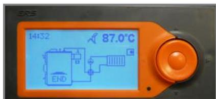
En fin de combustion, lorsque la température de fumées chute sous la température end la chaudière s'arrête automatiquement, l'écran affiche
