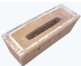
L'injecteur assure la diffusion de l'air secondaire dans le foyer de post combustion et assure le bon fonctionnement de la chaudière. Il est composé de béton réfractaire spécial haute température. Néanmoins de par sa position centrale, exposé aux chocs lors des chargements, ainsi que les contraintes liées aux températures très élevées, il est nécessaire de remplacer cette pièce régulièrement.
