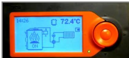
Après avoir validé la mise en marche de la chaudière en appuyant sur la touche ENTER, le servomoteur se positionne à l'ouverture (Servo 100%). Il varie entre 45 et 100%, afin d'optimiser la valeur Lambda ( $\lambda=1.35$ ). En position Servo 45%, l'air secondaire est fermé, en position Servo 0%, l'air primaire est fermé.
