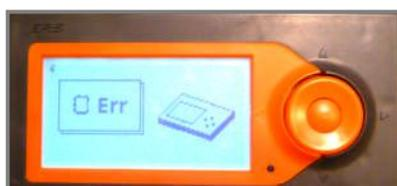
En appuyant sur la touche validation ● et en appuyant 3 fois sur la touche ▼ on accède à l'écran indiquant les dysfonctionnements électriques
