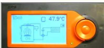
La chaudière est en phase de démarrage tant que la température de fumées n'a pas atteint la température mini. La température mini et maxi est paramétrable. Les paramètres standard sont de 90°C au mini et de 200°C au maxi.
