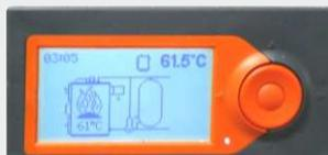
Tableau de commande chaudière Thermobois, d'utilisation simple et très convivial, rétro éclairé et à pictogrammes.
