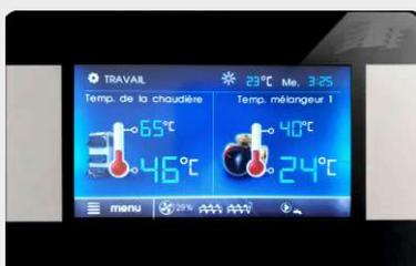
Le tableau de commande tactile, très facile d'utilisation, gère l'ensemble des automatismes de la chaudière: combustion, nettoyage des carnaux de fumées, aspiration de granulés du silo déporté vers le silo de la chaudière (option), pompe de recyclage.
