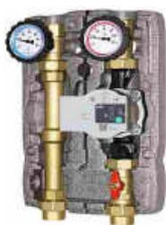
Module hydraulique M2 composé de 3 vannes à sphères, 2 thermomètres, circulateur électronique, clapet anti retour, jeu de raccords et tubulures laiton, coque isolante
