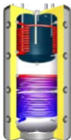
Ballon tampon à stratification, avec isolation, production d'eau chaude sanitaire, ballon émaillé, 4 départs et retours 1"½, , manchon pour résistance électrique, isolation épaisseur 100 mm, deux échangeurs solaire .
