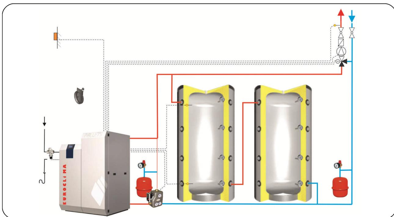
Il est nécessaire de vérifier le dimensionnement des unités de chauffe pour correspondre aux besoins des diverses installations et adapter les composants le cas échéant, en particulier le dimensionnement et la pression des vases d'expansion. Il est nécessaire de compléter les unités de chauffe: circulateur, vanne de mélange motorisée, purgeurs, ventilation chaufferie, tuyaux de fumées, tubages de cheminées etc, afin de réaliser une installation dans les règles de l'art.
