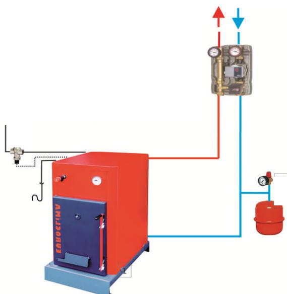
Installation avec vanne 4 voies obligatoire dans le cas d'un montage sans ballon tampon
