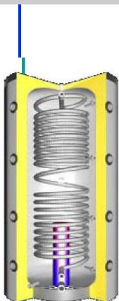
Ballon tampon à stratification, avec isolation, production d'eau chaude sanitaire instantanée par tube inox flexible, 4 départs et retours 1"½, , manchon pour résistance électrique, isolation épaisseur 100 mm
