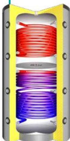
Ballon tampon acier avec isolation, 4 départs et retours 1"½, , manchon pour résistance électrique, isolation épaisseur 100 mm, deux échangeurs solaire .
