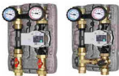
**Module direct énergie** composé de 3 vannes à sphères, 2 thermomètres, circulateur électronique, clapet anti retour, jeu de raccords et tubulures laiton, coque isolante
