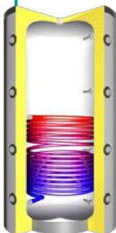
Ballon tampon acier avec isolation, 4 départs et retours 1"½, , manchon pour résistance électrique, isolation épaisseur 100 mm, échangeur solaire
