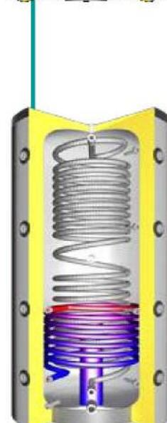
Ballon tampon à stratification, avec isolation, production d'eau chaude sanitaire instantanée par tube inox flexible, 4 départs et retours 1"½, , manchon pour résistance électrique, isolation épaisseur 100 mm, échangeur solaire
