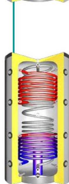
Ballon tampon à stratification, avec isolation, production d'eau chaude sanitaire instantanée par tube inox flexible, 4 départs et retours 1"½, , manchon pour résistance électrique, isolation épaisseur 100 mm, deux échangeur solaire .
