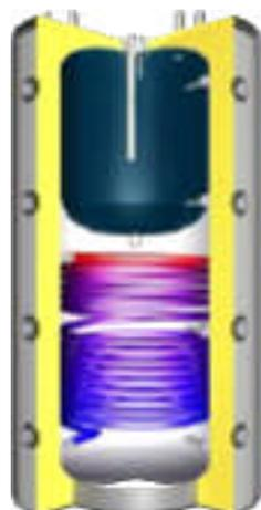
Ballon tampon à stratification, avec isolation, production d'eau chaude sanitaire, ballon émaillé, 4 départs et retours 1"½, , manchon pour résistance électrique, isolation épaisseur 100 mm, échangeur solaire
