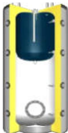
Ballon tampon à stratification, avec isolation, production d'eau chaude sanitaire, ballon émaillé, 4 départs et retours 1"½, , manchon pour résistance électrique, isolation épaisseur 100 mm
